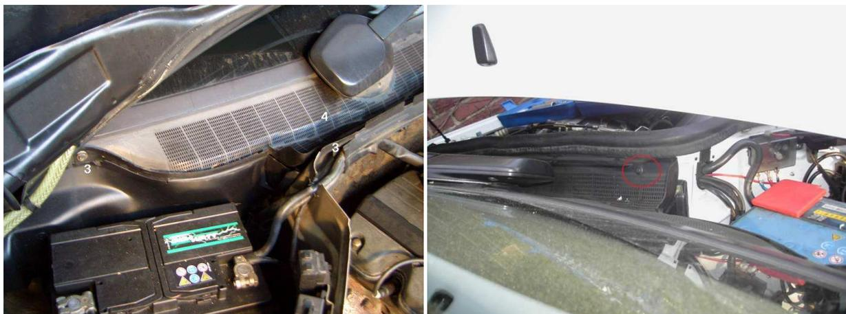
Die Schrauben (Pos. 5, SW 10, Bild links), mit denen der Lagerbock befestigt ist, lösen. Den Kabelkanal von der Stirnwand (Pos. 6, Bild links) nehmen Nun kann man mit viel Gefühl den kompletten Wischer mit Motor ausbauen. Wenn er etwas locker hängt den Anschlussstecker am Wischermotor abziehen (rot eingekreist, Bild rechts).
