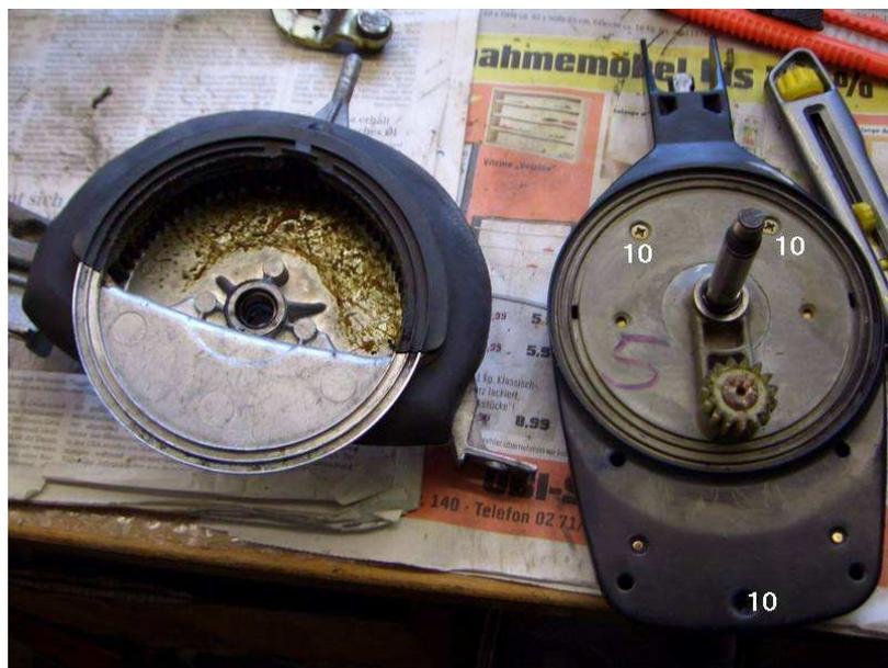
Der hier gezeigte Hubkolbenscheibenwischer kommt aus ein 93er 2.5D und sieht ein wenig anders aus. Leider ist hier der Zahnkranz gerissen, hier wird Ersatz benötigt.
