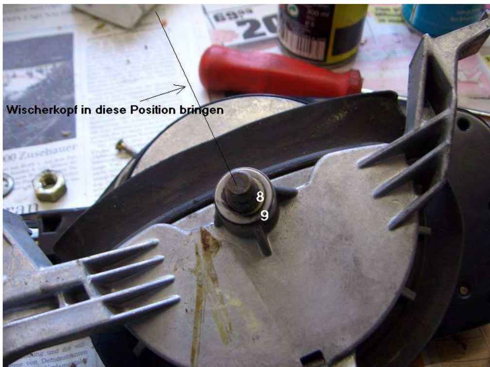
Die drei Kreuzschlitzschrauben (10) lösen und Ober- und Unterteil eventuell mit einem Teppichmesser/Schraubendreher voneinander lösen. Nun alles sauber machen und durch Drehen des Zahnrades sehen, was sich so bewegt. Als Reinigungshilfsmittel empfiehlt sich Bremsenreiniger oder Verdünnung, kein Aceton verwenden da dies sehr wahrscheinlich die Kunststoffteile auflöst. Sicherlich kann man diese durch ein selbst angefertigtes Alu-Zahnrad ersetzen aber lauter wird der Wischer alle male.
