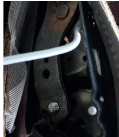
**[ Foto 5 ]** Jetzt kann man das Stahlteil zur Befestigung an der inneren Seite des Sitzrahmens ansetzen und mit der kleinen 10er Schraube von aussen fixieren. Allerdings sollte das ganze noch etwas Spiel haben.
