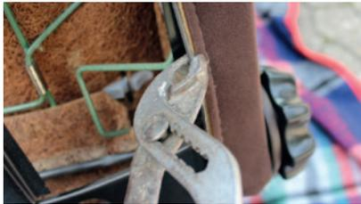
**[ Foto 2 ]** Als erstes entfernt man die Verkleidung auf der Rückseite der Fahrersitzes. Diese ist mit zwei Schrauben am unteren Ende befestigt. Oben ist die Verkleidung nur eingesteckt und kann nach unten herausgezogen werden.
