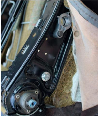
**[ Foto 6 ]** Als nächstes setzt man erst mal das silbergraue Distanzstück an das entsprechende Loch und spannt der Stoff darüber wieder an um an die richtige Stelle für das Loch zu markieren.
