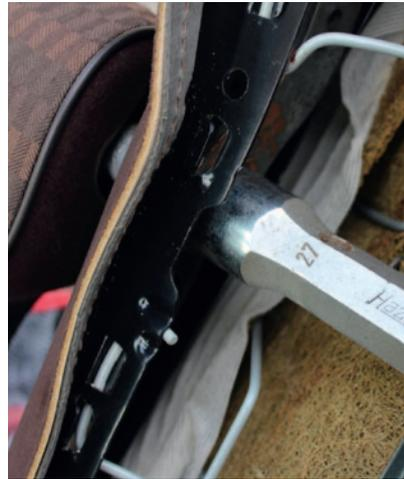
**[ Foto 7 ]** Nun kann man die Mittelarmlehne durchstecken und mit Unterlegling und 27er Mutter festgeschraubt. Danach kann man auch die 10er Schraube unten fest anziehen.
