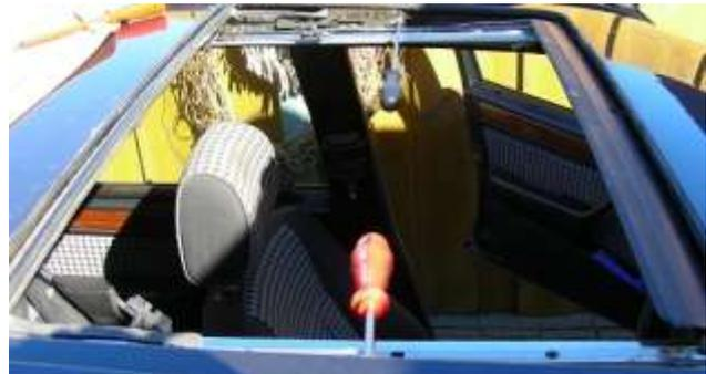
Beide Seiten mit 6mm Bohrer oder geeignetem Schraubendreher fixieren
