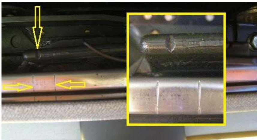
Markierung am Hubwinkel muß sich zwischen den Markierungen an der Führungsschiene befinden, wenn das Dach in Schiebestellung zugefahren wird und zum Stillstand kommt.
