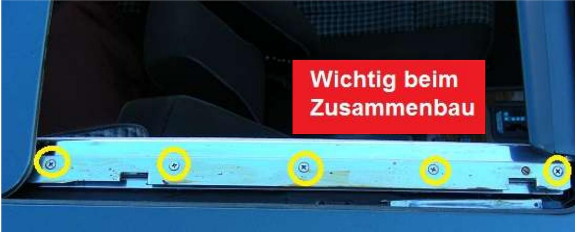
Beim geöffneten Schiebedach kommen rechts und links die Edelstahlführungsschienen zum Vorschein. Jede wird mit 5 Schrauben befestigt. **Die vorderste Schraube hat ein metrisches Gewinde.** Es ist wichtig, das beim Zusammenbau später genau diese Schraube nur leicht gegengezogen wird (nicht fest !!!!!) Sonst klemmt das Dach im vorderen Bereich.
